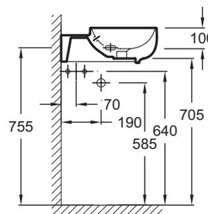
Descriptif CCTP : Lave-mains d'angle 46 x 46 cm. EGL112. Collection : NOUVELLE VAGUE. DIMENSIONS : 46 x 46 cm. POIDS : 12 kg. MATÉRIAU : Céramique. TYPE D'INSTALLATION : Autoportant. PERCEMENT ET PRÉ-PERCEMENT ROBINETTERIE : Percé 1 trou. PERCEMENT ROBINETTERIE : Percé 1 trou pour robinetterie. TROP-PLEIN : Avec trou de trop plein. PRODUIT INCLUS : (robinetterie non incluse). ROBINETTERIE CONSEILLÉE : Nouvelle Vague.
