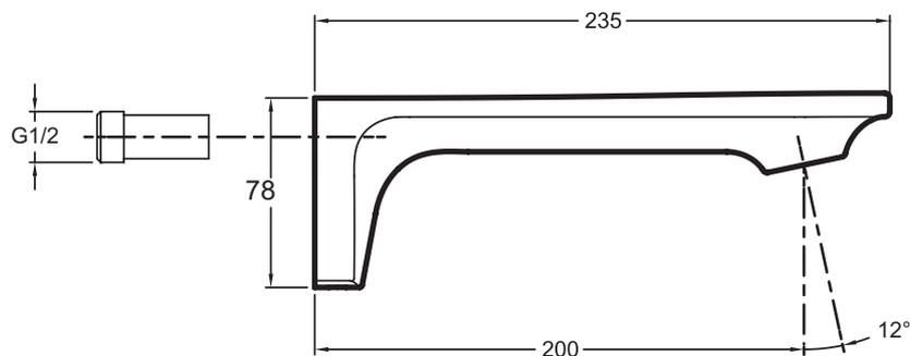
Descriptif CCTP : Bec bain mural (G1/2). E14795. Collection : STANCE. POIDS : 1,8 kg. TYPE D'INSTALLATION : Mural. TYPE D'ACCESSOIRE : Bec. Aérateur anti-calcaire.
