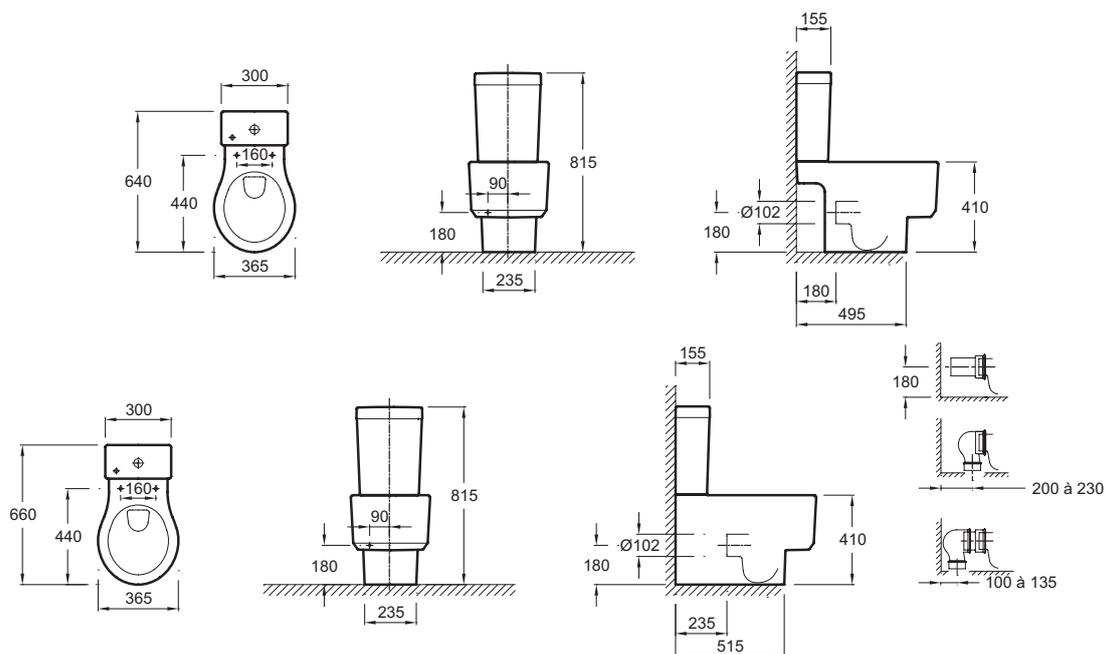
Спецификация продукта: Полностью оснащенный бачок на 3/6 л. E4771. Коллекция: RYTHMIK. Вес: 11,5 кг. Объем воды: Экономия воды: 2.6/4 л. Полностью оснащенный бачок с механизмом экономии воды на 3/6 литров E6248. Хромированная кнопка E6249.
