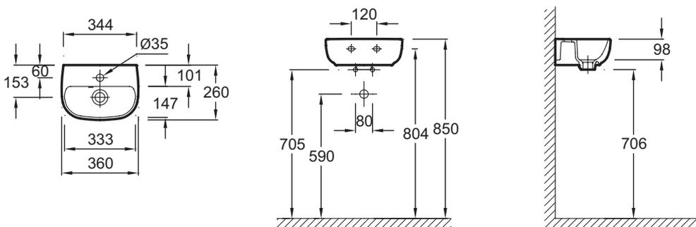
Спецификация продукта: Компактный раковина 36 x 26 см. E4761. Коллекция: ODEON UP. РАЗМЕРЫ (СМ): 36 x 26 см. ВЕС: 6,9 кг. МАТЕРИАЛ: Керамика. РАЗМЕТКА СВЕРЛЕНИЯ ОТВЕРСТИЯ ДЛЯ СМЕСИТЕЛЯ: С 1 отверстием для смесителя. ОТВЕРСТИЯ ДЛЯ СВЕРЛЕНИЯ: С 1 отверстием для смесителя. УСТАНОВКА: Угловые. ОТВЕРСТИЕ ПЕРЕЛИВА: С отверстием перелива. ПРОДУКТ В КОМПЛЕКТЕ: (смеситель заказывается отдельно). Рекомендуемые смесители: Aleo, стильный и широкий ассортимент.
