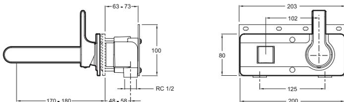
Спецификация продукта: Настенный смеситель для раковины. E10863. Коллекция: SINGULIER. ВЕС: 3,6 кг. ТИП УСТАНОВКИ: Крепление к стене. РАСХОД ВОДЫ: 14 л/мин при давлении 3 бар. РАССТОЯНИЕ МЕЖДУ ЦЕНТРОМ ИЗЛИВА И ЦЕНТРАЛЬНОЙ ОСЬЮ КОРПУСА: 170-180 мм. МЕХАНИЗМ: Картридж с регулируемым ограничителем температуры и чувствительным ограничителем расхода воды. СЛИВ: 0. ОДНОРЫЧАЖНЫЙ СМЕСИТЕЛЬ: 0. УСТАНОВКА: 2 отверстия. ГАРАНТИЯ НА ОТДЕЛКУ: 10 лет. Чувствительный ограничитель расхода воды.
