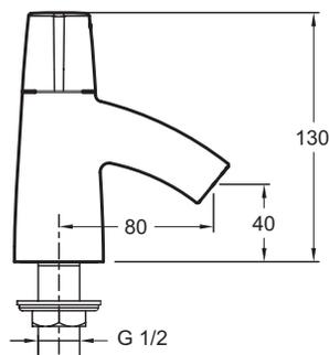
Спецификация продукта: Кран для умывальника (для холодной воды). E12817-7. Коллекция: ELEVATION. ВЕС: 0,8 кг. РАСХОД ВОДЫ: 8 л/мин при давлении 3 бар. МЕХАНИЗМ: Кран-буксы с керамическим диском. СЛИВ: Без донного клапана. УСТАНОВКА: 1 отверстие. Скрытая насадка с антиизвестковым покрытием, антивсплеск.
