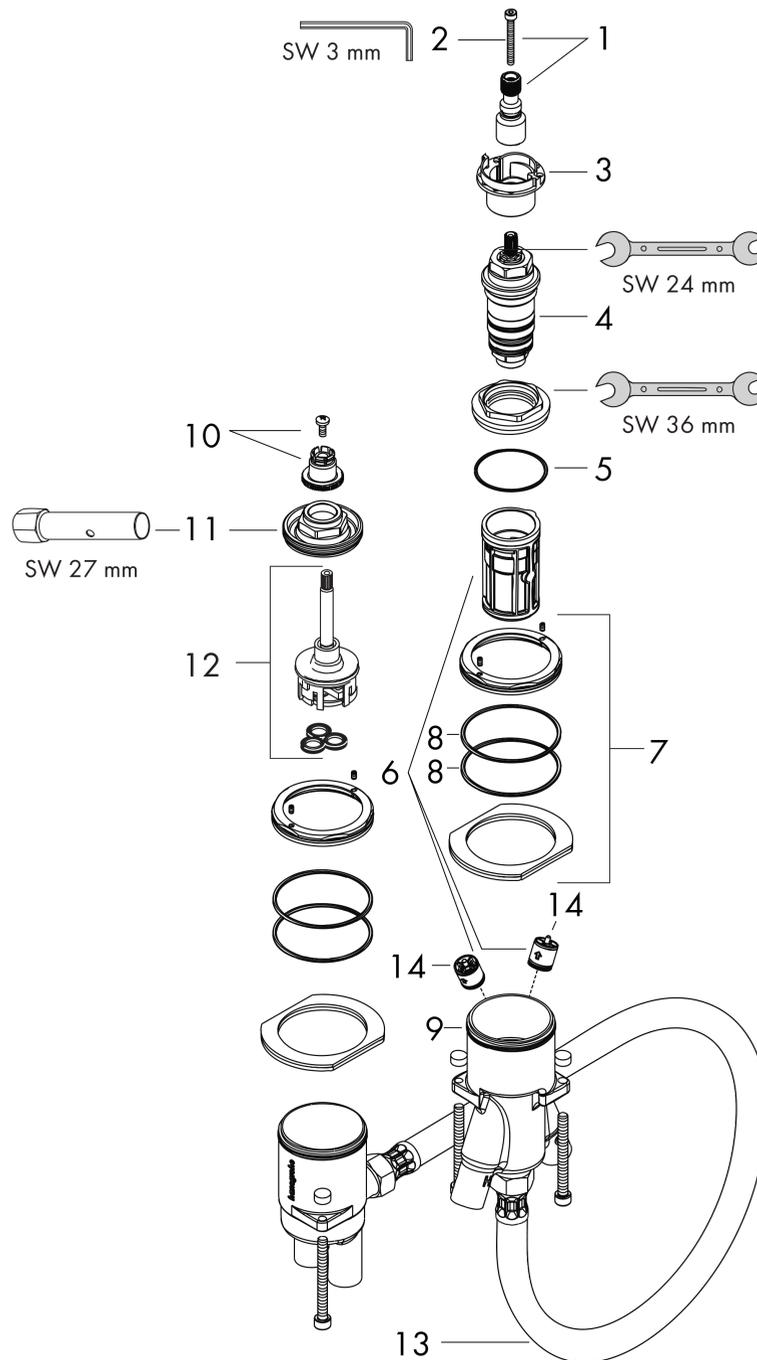
**Скрытая часть термостата на край ванны на 2 отверстия**
