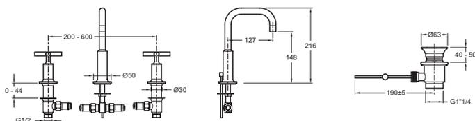
Descriptif CCTP : Mélangeur lavabo 3 trous, bec fixe. E144063. Collection : PURIST. POIDS : 3,5 kg. NORMES ET RÉGLEMENTATIONS : ACS : 15 ACC LY 081. DÉBIT (L/MN SOUS 3 BARS) : 10 l/mn. MÉCANISME : Têtes à disques céramique. VIDAGE : Avec vidage. TYPE D'INSTALLATION : 3 trous. GARANTIE MÉCANISME : 5 ans.
