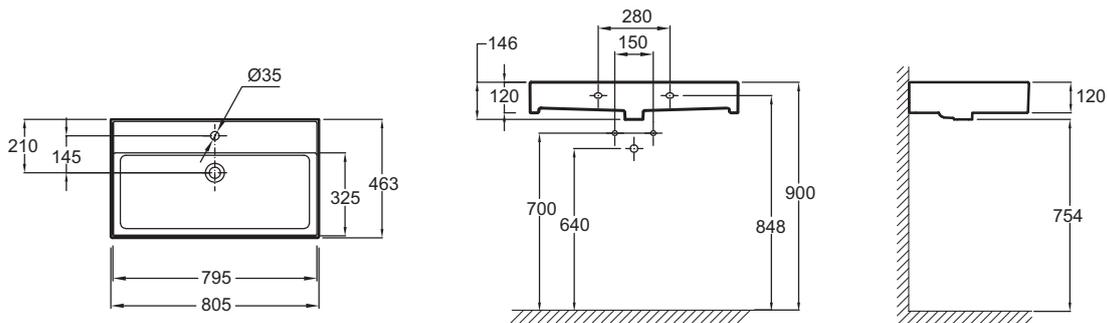
Спецификация продукта : Раковина-столешница 80 см. EXBI112. Коллекция : VIVIENNE. РАЗМЕРЫ (СМ) : 80.50 x 46.30 см. ВЕС : 20.8 кг. МАТЕРИАЛ : Огнеупорная керамика. ТИП УСТАНОВКИ : Подвесные.
