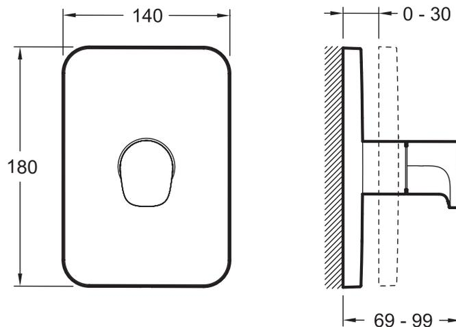
Descriptif CCTP : Inverseur 3+3 voies à encastrer - façade Hybrid. E75411. Collection : MODULO. POIDS : 2 kg. TYPE D'INSTALLATION : Mural. NORMES ET RÉGLEMENTATIONS : ACS : 14 ACCLY 511. TYPE D'ACCESSOIRE : Coude de raccordement. DESIGN DE ROBINETTERIE DE DOUCHE : HYBRIDE. TYPE DE SYSTÈME DE ROBINETTERIE DE BAIN : Avec Système Modulo.
