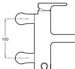
Спецификация продукта: Смеситель для ванны/душа, устанавливаемый на деку. E10868. Коллекция: SINGULIER. ВЕС: 4,3 кг. РАСХОД ВОДЫ: 20 л/мин при давлении 3 бар. МЕХАНИЗМ: Последовательный керамический картридж. РАЗМЕТКА ОТВЕРСТИЙ: 150 мм.
