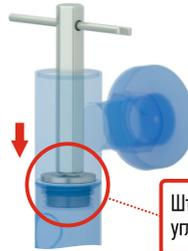
Штуцер для коллектора монтируется через углы при помощи ключа ШГ №12
