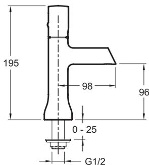
Спецификация продукта: Кран для холодной воды. Е8967. Коллекция: ТООБИ. ВЕС: 1,1 кг. РАСХОД ВОДЫ: 8 л/мин при давлении 3 бар. МЕХАНИЗМ: Керамический картридж для смесителя 25 мм. СЛИВ: Без донного клапана. УСТАНОВКА: 1 отверстие.
