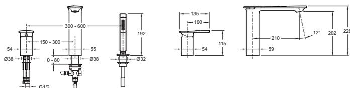
Descriptif CCTP : Mitigeur bain-douche 3 trous sur gorge. E14774. Collection : STANCE. POIDS : 4 kg. HAUTEUR TOTALE DU ROBINET (MM) : 228. RACCORDS : Avec raccords colonnettes. MÉCANISME : Cartouche à disques céramique. MITIGEUR DE BAIN : MITIGEUR. INVERSEUR : Inverseur automatique à l'arrière du bec. GARANTIE MÉCANISME : 5 ans. PERCEMENT : Ø percements spécifiques 2 x 40 mm et 1 x 35 mm. TYPE DE FLEXIBLE : Flexible lisse anti-torsion. Percements : 40 - 40 - 35. Aérateur anti-calcaire intégré.
