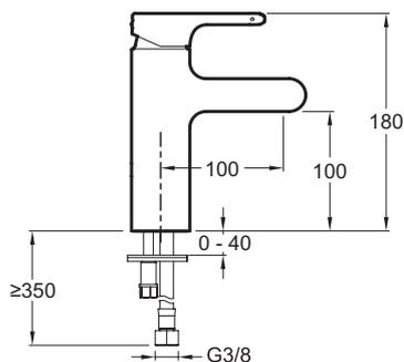
Descriptif CCTP : Mitigeur lavabo corps lisse, sans tirette, sans vidage. E10496. Collection : SINGULIER. POIDS : 2,5 kg. NORMES ET RÉGLEMENTATIONS : NF : I - ECAU : E1 C2 A2 U3. DÉBIT (L/MN SOUS 3 BARS) : 12 l/mn. RACCORDS : Avec flexibles d'alimentation. MÉCANISME : Cartouche à disques céramique. ENTRAXE (MM) : 180. VIDAGE : Sans vidage. TYPE D'INSTALLATION : 1 trou. GARANTIE MÉCANISME : 5 ans.
