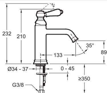
Спецификация продукта : Смеситель для раковины со сливом. E24360. Коллекция : LOUISE. МАТЕРИАЛ : N/A. ТИП УСТАНОВКИ : 1 отверстие. TYPE : Однорычажный. D@BIT (L/MN SOUS 3 BARS) : 5 л/мин. GARANTIE M@CANISME : 5 лет. GARANTIE FINITION : 10 лет.
