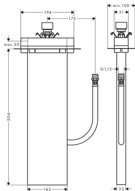
**sBox****Скрытая часть sBox для ванны, монтаж на край ванны или плитку**Поверхности : п.а.    Артикульный номер: **13560180**
