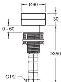
Спецификация продукта : Рычаг управления "Caresse" для смесителя. E77963-8A. Коллекция : GRANDS BOULEVARDS. МАТЕРИАЛ : Metal. ТИП УСТАНОВКИ : 2 отверстия.
