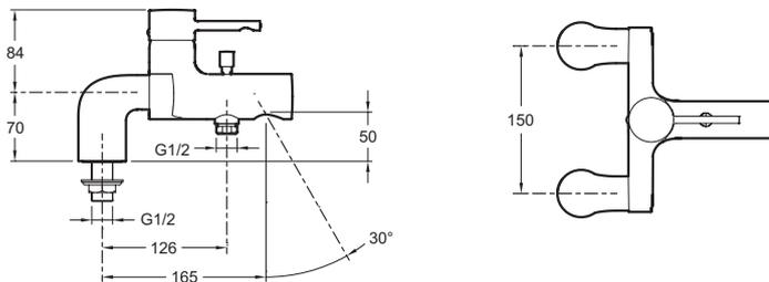
Спецификация продукта: Однорычажный смеситель для ванны/душа, устанавливаемый на деку. E37043. Коллекция: CUFF. Вес: 3,4 кг. Расход воды: 20 л/мин при давлении 3 бар.. Механизм: Керамический картридж. Разметка отверстий: 150 мм.
