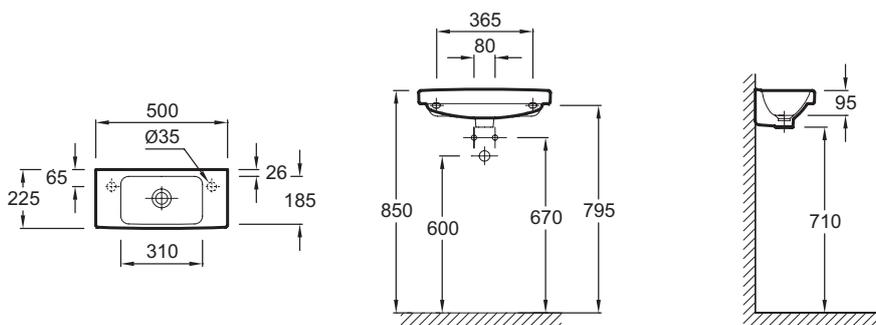
Спецификация продукта: Рукомойник 50 x 22.5 см, без переливного отверстия. E4699. Коллекция: ODEON UP. Размеры (см): 50 x 22,5 см. Вес: 6,6 кг. Разметка сверления отверстия для смесителя: 2 размеченных отверстия под смеситель. Без переливного отверстия.
