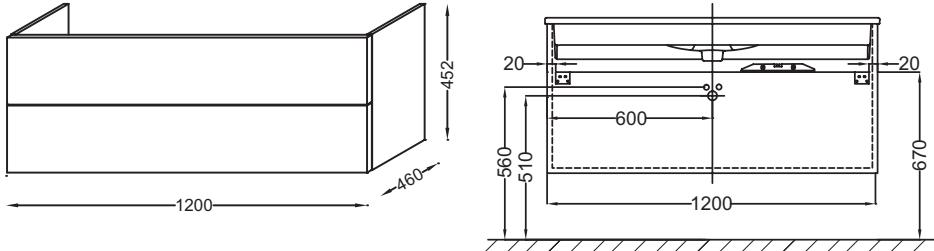
Спецификация продукта: Мебель для раковины-столешницы 120 см, угловая ручка. EB2071-R3. Коллекция: VOX. РАЗМЕРЫ (СМ): 120 x 46 x 45,20 см. ВЕС: 29 кг. МАТЕРИАЛ: Лак или меламин. НОРМЫ И ПРАВИЛА: NF. МЕСТО ДЛЯ ХРАНЕНИЯ: 2 выдвижных ящика с механизмом «плавное закрывание». РЕШЕНИЕ ХРАНЕНИЯ: Выдвижные ящики. ПРОДУКТ В КОМПЛЕКТЕ: (смеситель и раковина заказываются отдельно). РУЧКИ: Угловая ручка. ФИКСАЦИЯ: Установщику понадобится набор крепежей для монтажа на стену.
