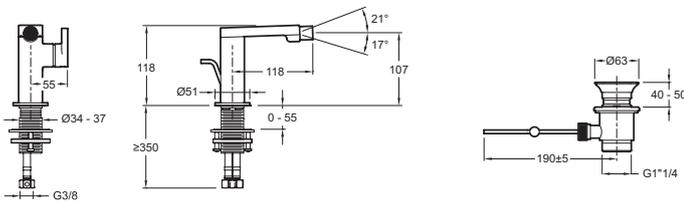
Descriptif CCTP : Mitigeur bidet - levier hôtellerie. E73176. Collection : COMPOSED. POIDS : 2,5 kg. NORMES ET RÉGLEMENTATIONS : ACS : 14 ACC LY 511. DÉBIT (L/MN SOUS 3 BARS) : 5 l/mn. HAUTEUR TOTALE DU ROBINET (MM) : 118. SAILLIE DU BEC (MM) : 118. RACCORDS : Avec flexibles d'alimentation. MÉCANISME : Cartouche à disques céramique. VIDAGE : Avec vidage. TYPE DE BEC : Rotule orientable. TYPE D'INSTALLATION : 1 trou. GARANTIE MÉCANISME : 5 ans. Aérateur anti-calcaire sur rotule orientable..
