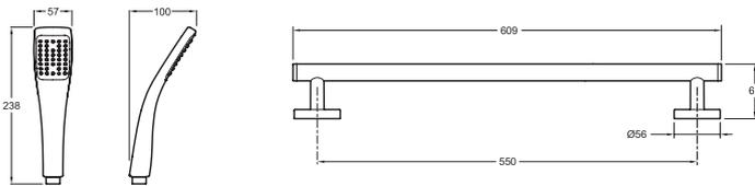
Спецификация продукта: Душевой комплект с металлической штангой 0,60 м. E99938. Коллекция: EO. Размеры (см): 60 x 0 см. Тип установки: Крепление к стене. Гибкий нескручивающийся шланг : 1600 мм с 1 вращающейся гайкой. Регулируемый слайд-держатель душа. Осевое расстояние между креплениями : 550 мм. Металлическая пластинка : Диаметр 22 мм - длина 609 мм. Настенные крепежи : Диаметр 56 мм.
