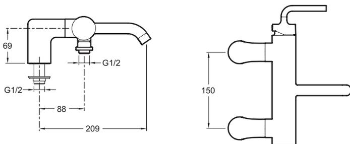
Спецификация продукта: Смеситель для ванны/душа, устанавливаемый на деку. E14500-4A. Коллекция: PURIST. ВЕС: 4,5 кг. РАСХОД ВОДЫ: 23 л/мин при давлении 3 бар. МЕХАНИЗМ: Последовательный керамический картридж. РАЗМЕТКА ОТВЕРСТИЙ: 150 мм.
