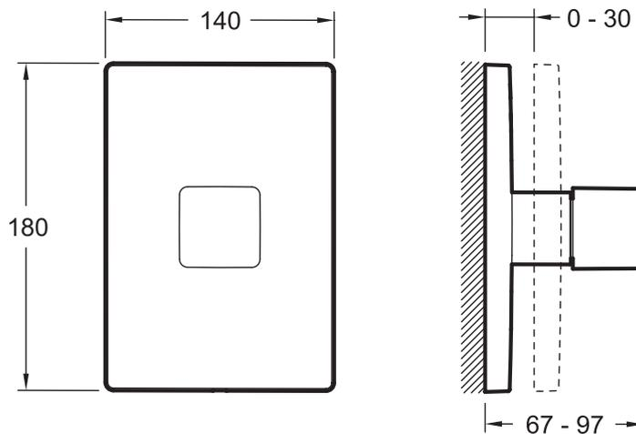
Descriptif CCTP : Inverseur 3+3 voies à encastrer - façade Square. E75413. Collection : MODULO. POIDS : 2 kg. TYPE D'INSTALLATION : Encastré. NORMES ET RÉGLEMENTATIONS : ACS : 14 ACC LY 511. TYPE D'ACCESSOIRE : Support pour douche. DESIGN DE ROBINETTERIE DE DOUCHE : CONTEMPORAIN CARRÉ. TYPE DE SYSTÈME DE ROBINETTERIE DE BAIN : Avec Système Modulo.
