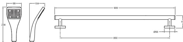
Спецификация продукта: Душевой комплект с металлической штангой 0,90 м. Е99940. Коллекция: Е0. Размеры (см): 90 x 0 см. Тип установки: Крепление к стене. Металлическая пластина : Диаметр 22 мм - длина 909 м. ибкий нескручивающийся шланг : длина 1600 мм с 1 вращающейся гайкой. Ручной душ Е0 Large : выпускных отверстий с антиизвестковым покрытием. Мыльница. Регулируемый слайд-держатель душа. Осевое расстояние между креплениями : 850 мм. Настенные крепежи : Диаметр 56 мм.
