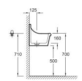
Descriptif CCTP : Vidoir mural livré avec insertas. E1898. Collection : NORMA. DIMENSIONS : 45 x 35 cm. POIDS : 14,2 kg. MATÉRIAU : Céramique. FIXATIONS : Attaches fonte en option E4598. Version non perçée.
