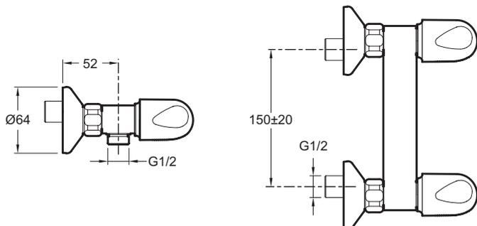
Спецификация продукта: Настенный смеситель для душа. E71923. Коллекция: GALEO CD. ВЕС: 1,1 кг. ТИП УСТАНОВКИ: Крепление к стене. ТИП: Двурывчажний. РАСХОД ВОДЫ: 14 л/мин при давлении 3 бар. ПОДКЛЮЧЕНИЕ: С соединителями и настенными крепежами. МЕХАНИЗМ: Кран-буксы с керамическим диском. РАЗМЕТКА ОТВЕРСТИЙ: 150 ± 20 мм. СЛИВ: 0. ОДНОРЫЧАЖНЫЙ СМЕСИТЕЛЬ: 0. УСТАНОВКА: 2 отверстия. ГАРАНТИЯ НА ОТДЕЛКУ: 0. Обратный клапан на выходе для душа.
