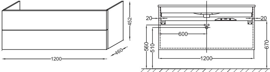
Спецификация продукта: Мебель для раковины-столешницы 120 см, изогнутая ручка. EB2071-R1. Коллекция: VOX. РАЗМЕРЫ (СМ): 120 x 46 x 45,20 см. ВЕС: 29 кг. МАТЕРИАЛ: Лак или меламин. НОРМЫ И ПРАВИЛА: NF. МЕСТО ДЛЯ ХРАНЕНИЯ: 2 выдвижных ящика с механизмом «плавное закрывание». РЕШЕНИЕ ХРАНЕНИЯ: Выдвижные ящики. ПРОДУКТ В КОМПЛЕКТЕ: (смеситель и раковина заказываются отдельно). РУЧКИ: Изогнутая ручка. ФИКСАЦИЯ: Установщику понадобится набор крепежей для монтажа на стену.
