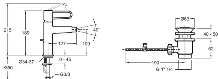
Descriptif CCTP : Mitigeur bidet personnalisable, avec vidage. E21033-CP. Collection : ODÉON RIVE GAUCHE. DIMENSIONS : 12,70 x 21,50 cm. POIDS : 1,3 kg. TYPE D'INSTALLATION : 1 trou. TYPE : Mitigeur. DÉBIT (L/MN SOUS 3 BARS) : 5 l/mn. SAILLIE DU BEC (MM) : 127. RACCORDS : Avec flexibles d'alimentation.
