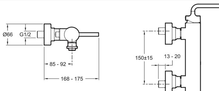
Descriptif CCTP : Mitigeur douche mural. E14590-4A. Collection : PURIST. POIDS : 3,1 kg. TYPE D'INSTALLATION : Mural. NORMES ET RÉGLEMENTATIONS : ACS : 14 ACC LY 511. DÉBIT (L/MN SOUS 3 BARS) : 14 l/mn. RACCORDS : Avec raccords et rosaces murales. MÉCANISME : Cartouche à disques céramique. ENTRAXE (MM) : 150 ± 15. TYPE D'INSTALLATION : 2 trous. GARANTIE MÉCANISME : 5 ans. Bague-limiteur de température.
