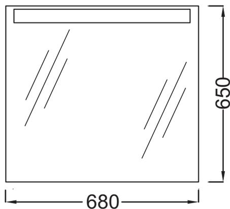
Спецификация продукта: Зеркало 68 см. EB1108. Коллекция: PRESQU'ILE. Размеры (см): 68 x 5 x 65 см. Вес: 15,5 кг. Включение: 230В, 24Вт, интегрированный патрон Т5, класс II, IP 45.
