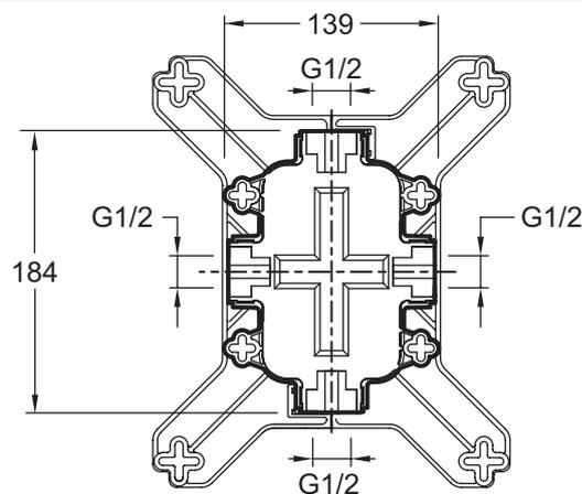
Спецификация продукта: Универсальная система скрытого монтажа. 98699D. Коллекция: MODULO. Вес: 2 кг. Тип установки: Встраиваемые. Рабочее давление: рабочее давление между 1 и 6 бар, рекомендованное давление 3 бар. Температура при использовании: Температура горячей воды между 55 и 65°C, рекомендовано 60°C.
