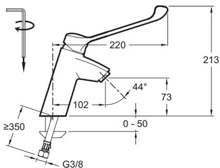
Спецификация продукта: Смеситель для раковины Panache, без донного клапана. E18162. Коллекция: EASY. ВЕС: 1,5 кг. РАСХОД ВОДЫ: 13 л/мин при давлении 3 бар. ПОДКЛЮЧЕНИЕ: С гибкой подводкой. МЕХАНИЗМ: Последовательный керамический картридж. СЛИВ: 0. ОДНОРЫЧАЖНЫЙ СМЕСИТЕЛЬ: 0. УСТАНОВКА: 1 отверстие. ГАРАНТИЯ НА ОТДЕЛКУ: 0. Простая установка коленного соединения (на уровне 150 мм).
