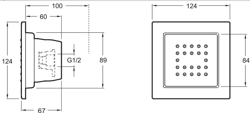
Спецификация продукта: Квадратная форсунка, 22 выпускных отверстия. E8003. Коллекция: WATERTILE. РАЗМЕРЫ (CM): 12,40 x 12,40 см. ВЕС: 0,8 кг. ТИП СИСТЕМЫ: С СИСТЕМОЙ MODULO. Поворотная, скрытый монтаж.
