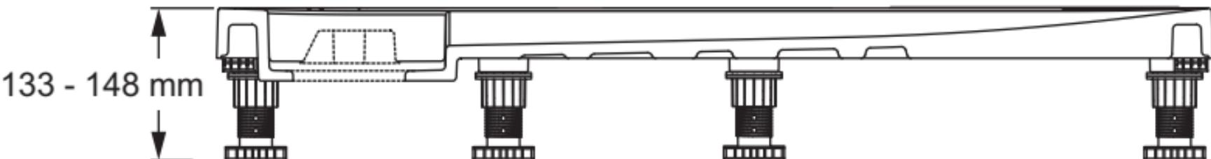
Hauteur mini / maxi Châssis avec receveur
