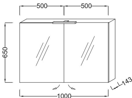
Спецификация продукта: Зеркальный шкаф 100 см со светодиодной подсветкой. EB797RU. Коллекция: REVE. Размеры (см): 100 x 14,30 x 65 см. Вес: 20 кг. Место для хранения: 2 дверцы с двойным зеркалом. Включение: 230В, 3.5Вт, класс II, IP 44. Лакированное покрытие: внутренняя сторона серого цвета. Матовое покрытие: внешние и боковые панели.
