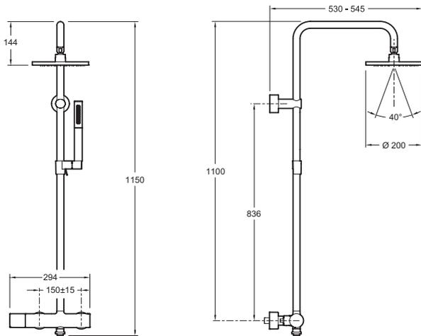
Спецификация продукта: Душевая колонна со смесителем для душа и круглым верхним душем 200 мм. E15370. Коллекция: TOOVI. РАЗМЕРЫ (СМ): 20 x 20 см. ВЕС: 7 кг. ТИП УСТАНОВКИ: Крепление к стене. АКСЕССУАРЫ: 0. НАЛИЧИЕ СМЕСИТЕЛЯ: СО СМЕСИТЕЛЕМ. ОДНОРЫЧАЖНЫЙ СМЕСИТЕЛЬ: МЕХАНИЧЕСКИЙ. КЛАССИФИКАЦИЯ: МЕХАНИКА. ФОРМА ВЕРХНЕГО ДУША: КРУГЛЫЙ. ПЕРЕКЛЮЧАТЕЛЬ: 0. ТИП ШЛАНГА: Нескручивающийся. Душевая колонна со смесителем для душа и круглым верхним душем.. Двухрежимный ручной душ Shift Elipse.
