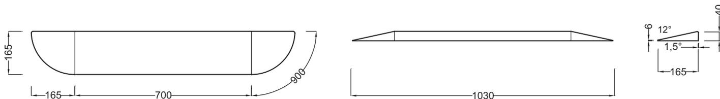
Спецификация продукта: Пандус для людей с ограниченными возможностями с гелевым покрытием. E62499. Коллекция: FLIGHT. РАЗМЕРЫ (CM): 103 x 165 x 4 см. ВЕС: 5 кг. МАТЕРИАЛ: Flight (композит+акрил). АКСЕССУАРЫ: Бортик. РИСУНОК ПОВЕРХНОСТИ: Гладкая. Высота 4 см, длина 103 см, есть возможность обрезки ширины. Подходит к поддонам коллекции Flight.
