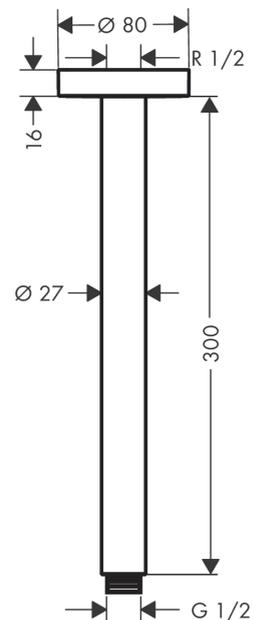
**Потолочное подключение S, 300 мм**
