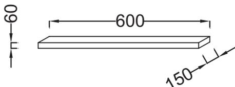
Спецификация продукта: Полочка 60 см. EB500. Коллекция: PARALLEL. РАЗМЕРЫ (СМ): 60 x 15 x 6 см. ВЕС: 3,5 кг. МАТЕРИАЛ: ДСП Меламин. ДОПОЛНИТЕЛЬНЫЙ МОДУЛЬ: Полки. ФИКСАЦИЯ: Невидимые крепежи.
