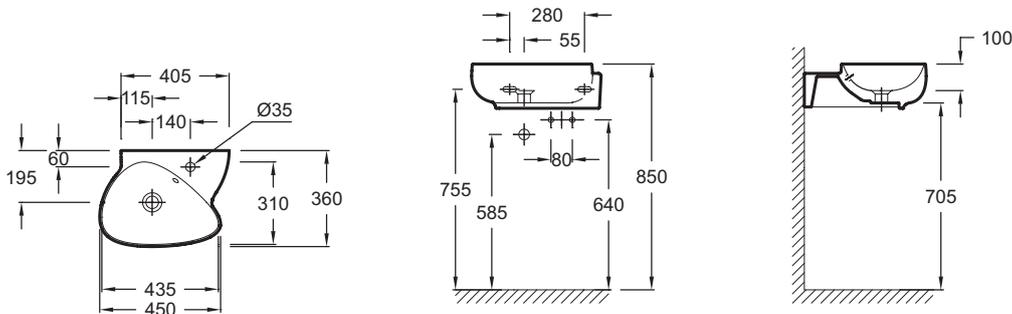
Descriptif CCTP : Lave-mains 45 x 36 cm. EGK112. Collection : NOUVELLE VAGUE. DIMENSIONS : 45 x 36 cm. POIDS : 12 kg. MATÉRIAU : Céramique. TYPE D'INSTALLATION : Autoportant. PERCEMENT ET PRÉ-PERCEMENT ROBINETTERIE : Percé 1 trou. PERCEMENT ROBINETTERIE : Percé 1 trou pour robinetterie. TROP-PLEIN : Avec trou de trop plein. PRODUIT INCLUS : (robinetterie non incluse). ROBINETTERIE CONSEILLÉE : Nouvelle Vague.
