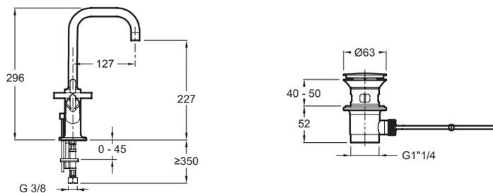
Спецификация продукта: Высокий двухвентильный смеситель для раковины с донным клапаном. E14595-3. Коллекция: PURIST. ВЕС: 2,5 кг. МЕХАНИЗМ: Кран-буксы с керамическим диском. СЛИВ: С донным клапаном. УСТАНОВКА: 1 отверстие. Вращающийся излив.
