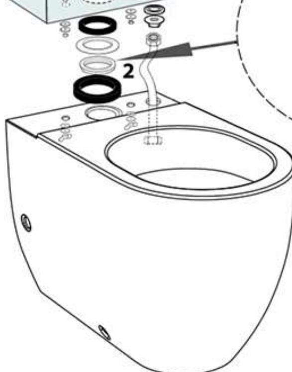
come da disegno **2** usare l'apposita chiave in dotazione per stringere e serrare, così da far aderire bene la guarnizione della batteria alla cassetta in ceramica.
