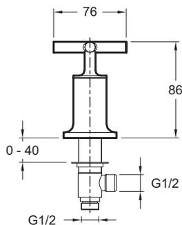
Спецификация продукта: Ручки для смесителя на ванну. E144293. Коллекция: PURIST. ВЕС: 2,8 кг. РАСХОД ВОДЫ: 43 л/мин. МЕХАНИЗМ: Кран-буксы с керамическим диском. УСТАНОВКА: 2 отверстия. Минималистичный, покрытие медь.
