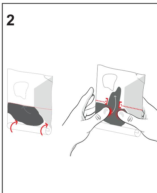
**DE** Klebstoffkammer umfalten und den Klebstoff in Richtung der schmalen Reaktionskammer drücken, bis die Trennnaht aufplatzt.
