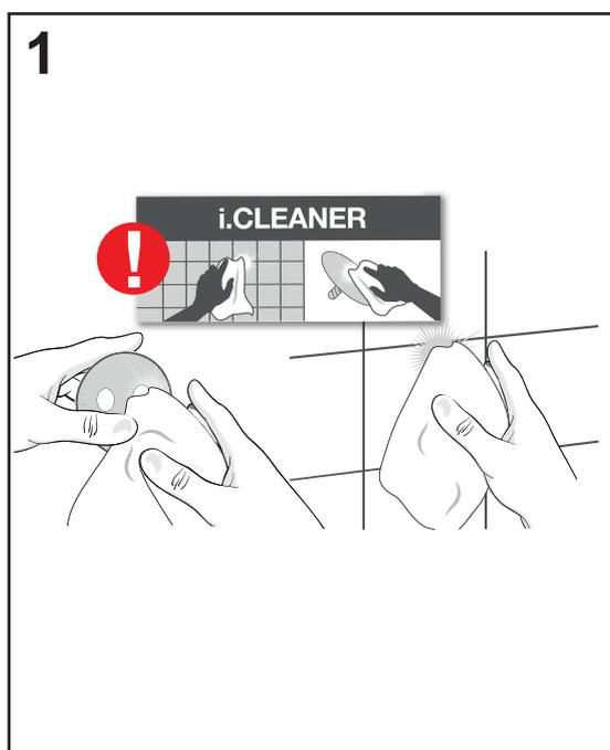
**DE** Klebefläche der Montageplatte und die Fliesenfläche gründlich mit dem Reinigungstuch i.CLEANER reinigen.
