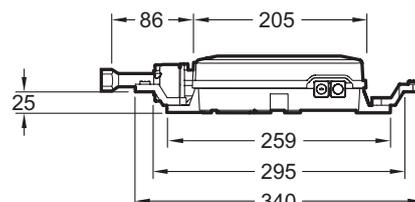
Спецификация продукта: Встроенный термостатический клапан - 2 выхода. 528D-K. Коллекция: DTV PROMPT. Размеры (см): 34 x 31,80 x 6,80 см. Вес: 2,7 кг. Тип установки: Встраиваемые. 2 блока G1/2, 2 выхода G1/2.
