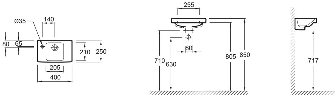
Descriptif CCTP : Lave-mains 40 cm, sans trop-plein. E4759C-X5. Collection : ODÉON UP. DIMENSIONS : 40 x 25 cm. MATÉRIAU : Céramique. TYPE D'INSTALLATION : Autoportant. PERCEMENT ET PRÉ-PERCEMENT ROBINETTERIE : Percé 1 trou à gauche. PERCEMENT ROBINETTERIE : Percé 1 trou pour robinetterie. CONFIGURATION : STANDARD. TROP-PLEIN : Sans trou de trop plein. PRODUIT INCLUS : (robinetterie non incluse). Sans trop-plein.
