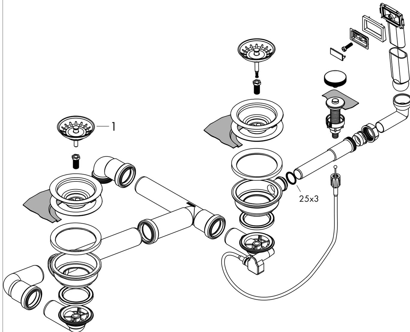
**D17-11 Автоматическая система слива-перелива для гранитной мойки с двумя чашами**
