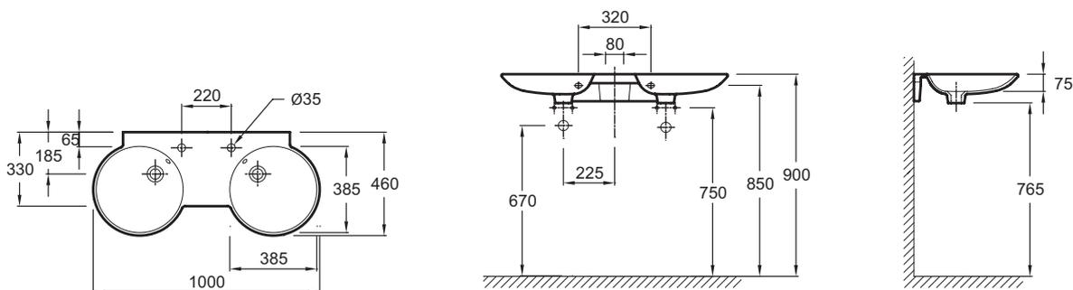
Спецификация продукта: Двойная подвесная раковина-столешница 100 x 33/46 см. E4502. Коллекция: SPHERIK. Размеры (см): 100 x 46 см. Вес: 16,6 кг. Разметка сверления отверстия для смесителя: С 1 отверстием для каждого смесителя. Дополнительная опция: полотенцесушитель (хром/черная матовая сталь).
